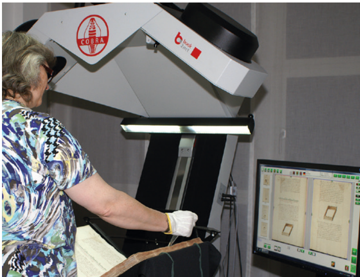
Abb. 1: Scannen einer Handschrift am V-Scanner Cobra.
