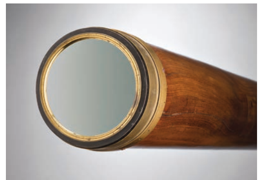
Das achromatische Objektiv des Dollond-Refraktors (Foto: Klaus Luginland, Technoseum Mannheim)
