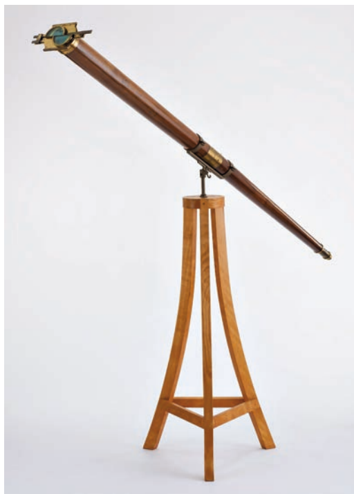
Das Linsenfernrohr mit vorgesetztem Heliometerobjektiv, beide aus der Werkstatt von Peter Dollond, London, um 1769 (Foto: Klaus Luginsland, Technoseum Mannheim)
