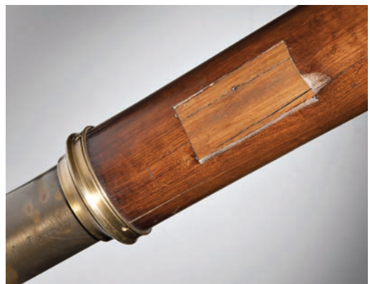
Deutlich erkennbar sind die späteren Holzflückungen am Tubus des Fernrohrs (Foto: Klaus Luginland, Technoseum Mannheim)
