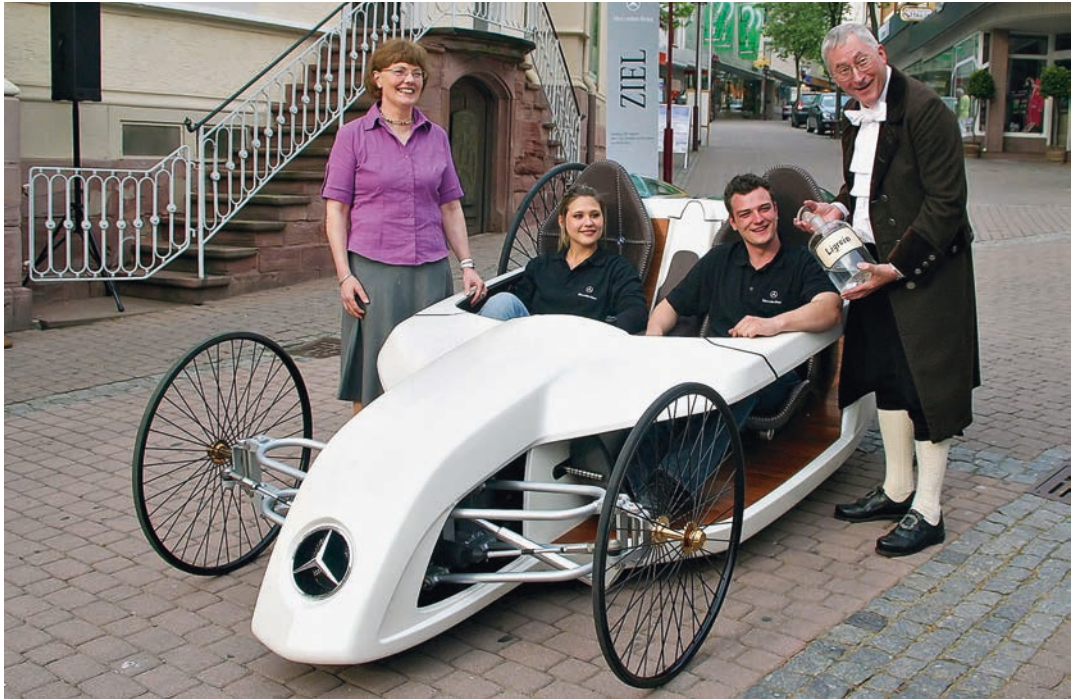
Es geht auch anders! Als Ausbildungsprojekt im Werk Sindelfingen entstand der F-Cell-Roadster, dessen elektrische Antriebsenergie aus Wasserstoffgas mit einer Brennstoffzelle gewonnen wird. Das Bild entstand 2009 bei der Jungfernfahrt vom Mannheimer Maimarkt zum Ziel Stadt-Apotheke in Wiesloch (Adolf Suchy)
