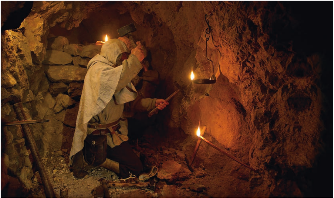
Mittelalterlicher Vortrieb mit Schlägel & Eisen. Experimentelle Archäologie im St.-Anna-Stollen (Foto B. Fuchs)
