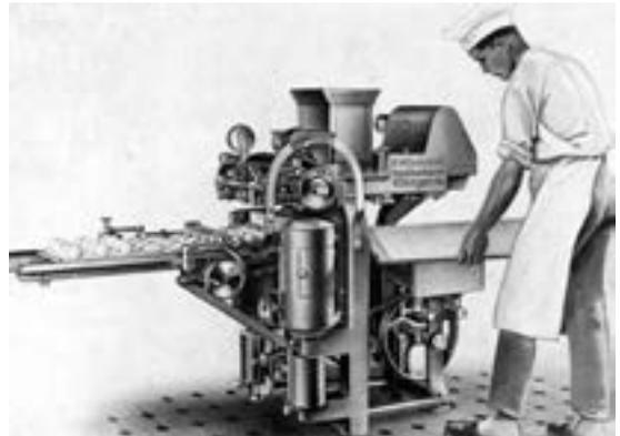
Abb. 3: Vollautomatische Brötchenteigteil- und Rundwirk- maschine „Derby“, Modell 1925. Winkler-Werkszeitung 1, 1963.
