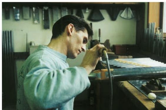
*Millimeterarbeit ist bei der Herstellung der Metallpfeifen aus einer Zinn-Blei-Legierung gefragt. Die auf gewünschte Größe zugeschnittenen Platten werden aufgerollt und an Schnittstellen und Kern zugelötet.*
