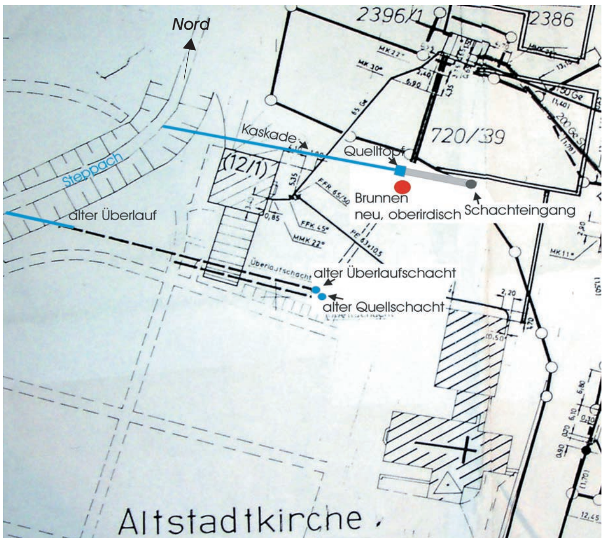
Lageplan der Altstadtquellanlage mit Brunnen, Kaskade und (gelegentlichem) Überlauf. Grundlage: Katasterplan der Stadt Villingen vor 1972, ohne Maßstab.
