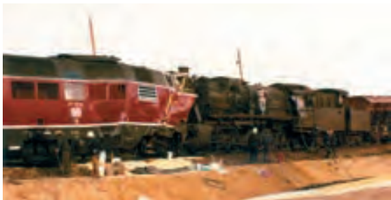
Abb. 13: Frontalzusammenstoß einer Diesellok vom Typ V200.1 mit einem dampfbespannten Leerzug (Baureihe 50) im Bereich der ehemaligen Direktionsgrenze (Manfred Krümmer).
