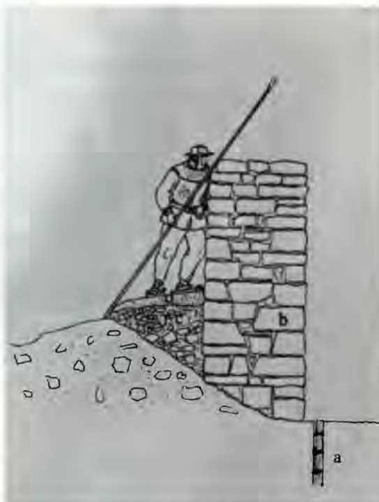
Letzimauer: a) Holzplanken zur Stützung der Fundamente, b) Mauer aus Kalksteinen und Findlingen, lagenmäßig aufgeschichtet und fest vermörtelt, c) Aufschüttung an der Südseite, d) gegossener Mörtelboden für den Verteidiger.
