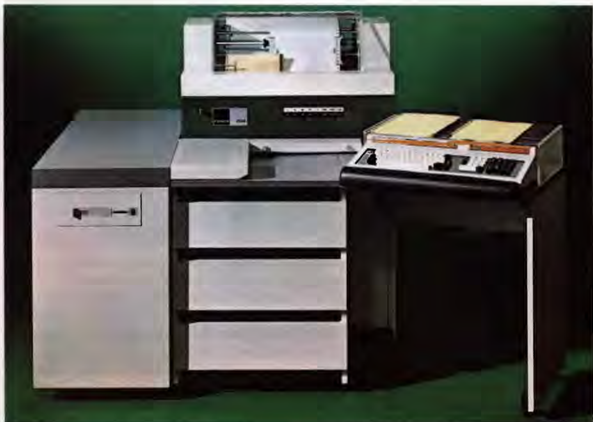
Der Magnetknoten-Computer Kienzle 6000 setzte internationale Maßstäbe auf dem Gebiet der Mittleren Datentechnik.
