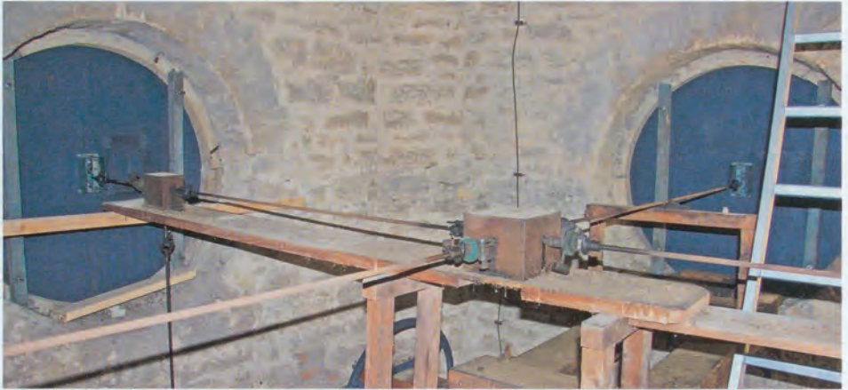
Zifferblätter mit Zentralgetriebe und Doppelstangen
