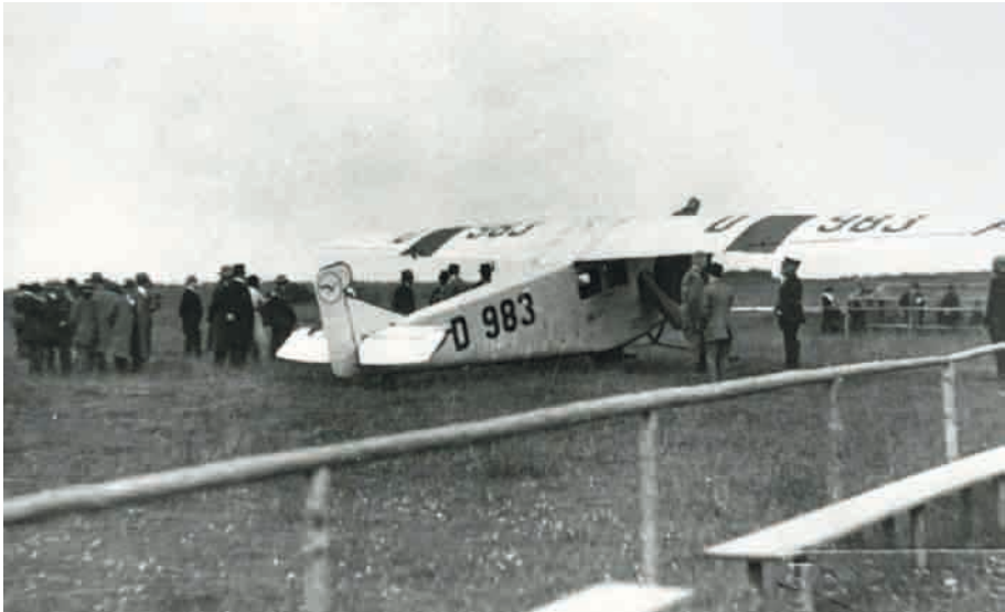
Die von Pilot Spöhrle geflogene D-983 „Kissingen“ vom Typ Junkers K 16 nach der Landung. Datum der Aufnahme unbekannt.
