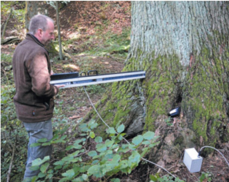
Schonende Altersermittlung mit dem Resistographen (Fa. Rinntech).
