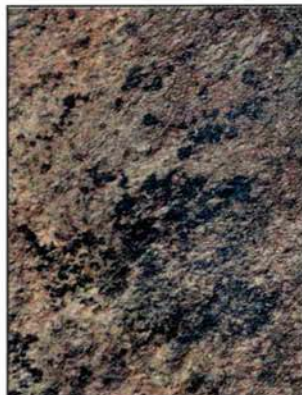
Abb. 14: Frisch aufgeschlagene Bruchfläche mit tonigem, durch Limonit hellbraun gefärbtem Belag. Schwärzliche Flecken zeigen die Beteiligung eines Manganoxid-Mineralen an. Trotz der geringen Dicke des Belags (wenige Zehntel mm) ist von den Mineralen und dem Gefüge des Leptinites nichts mehr zu sehen
