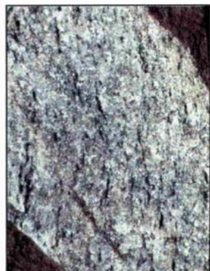
Abb. 12: Frisch aufgeschlagene Bruchfläche; die unverwitterten Hauptminerale (Feldspäte, Quarz und Biotit) sowie das Gefüge des Gesteins sind gut erkennbar
