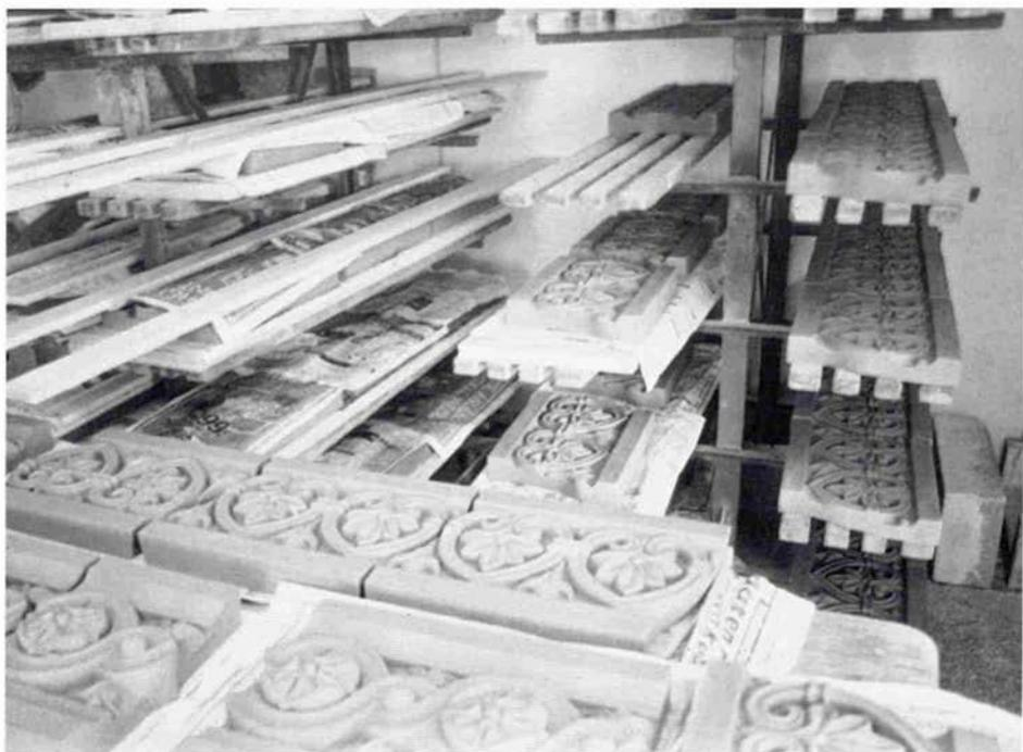
Abb. 4: Satz der Rohlinge bei der Lufttrocknung
