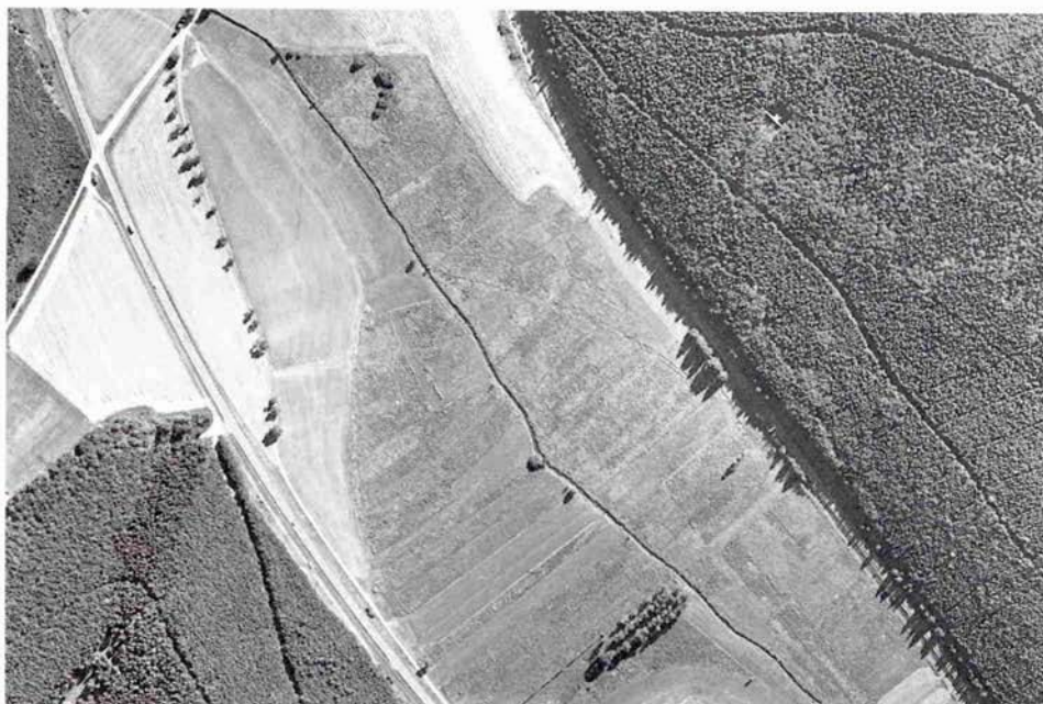
Abb. 1: Luftbild vom 31.8.1991, Maßstab: ca. 1:7200. Die "Einöde" vor der Renaturierung. Deutlich erkennbar ist der begradigte Verlauf der Aitrach mit den linienförmigen Seitengräben. (Landesvermessungsamt Baden-Württemberg, 27.8.1998, Az.: 4.47/391)
