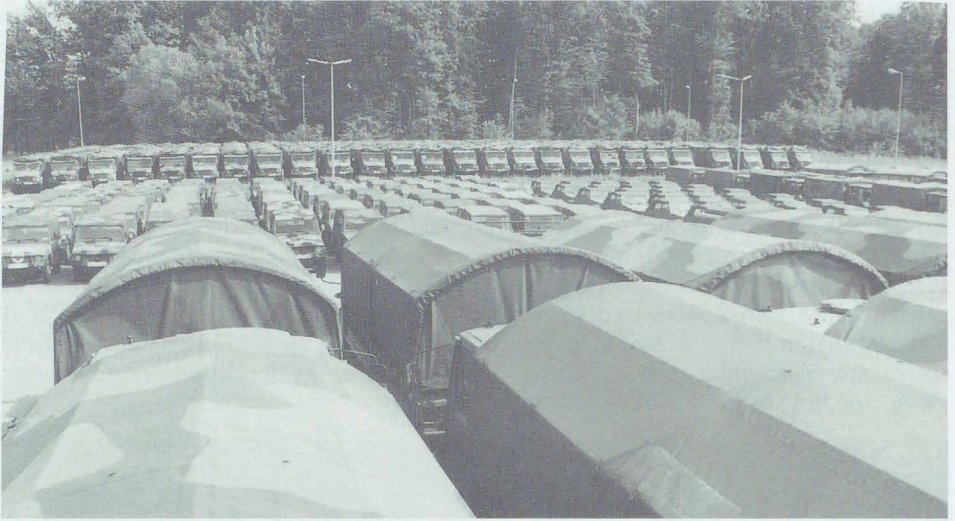
Abb. 26: Freilagerfläche für Lkw und Pkw, an Ölabscheider angeschlossen
