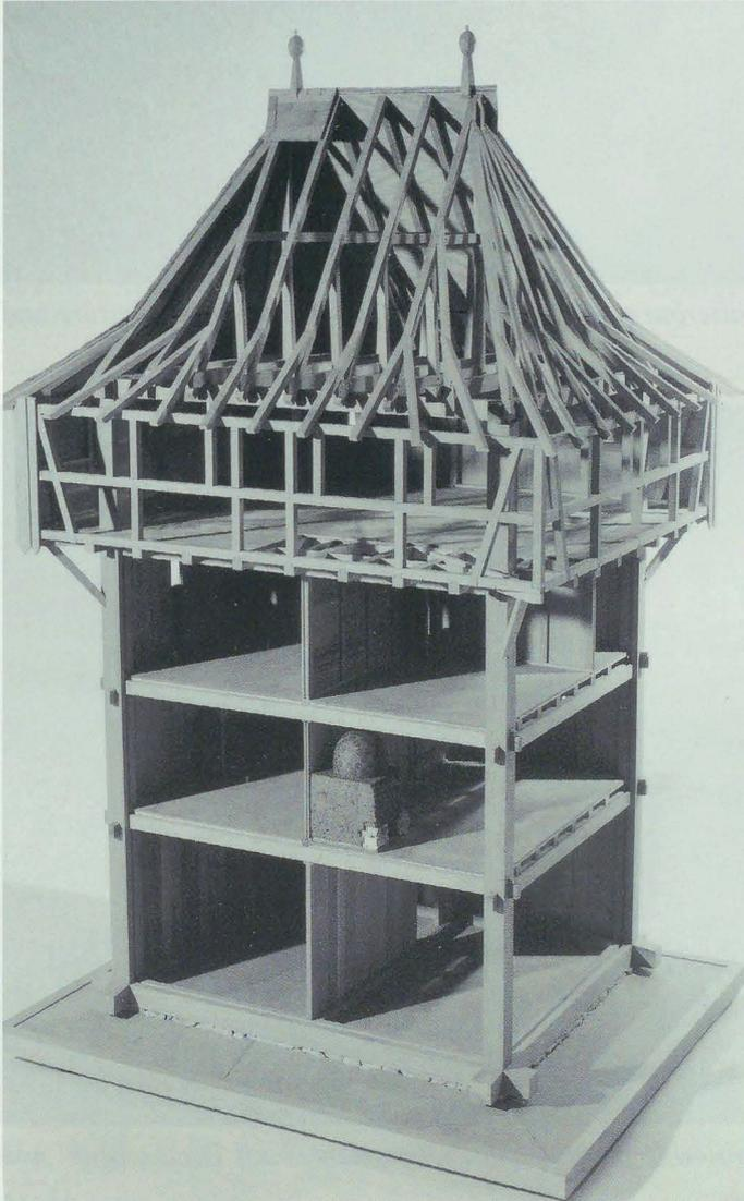
*Abb. 5: Eschelbronn, Periode III, bzw. Kanzach, Bachritterburg. Modell der Wohnturmrekonstruktion von 2000/01 (ohne Zugeständnisse an moderne Bauvorschriften).*
