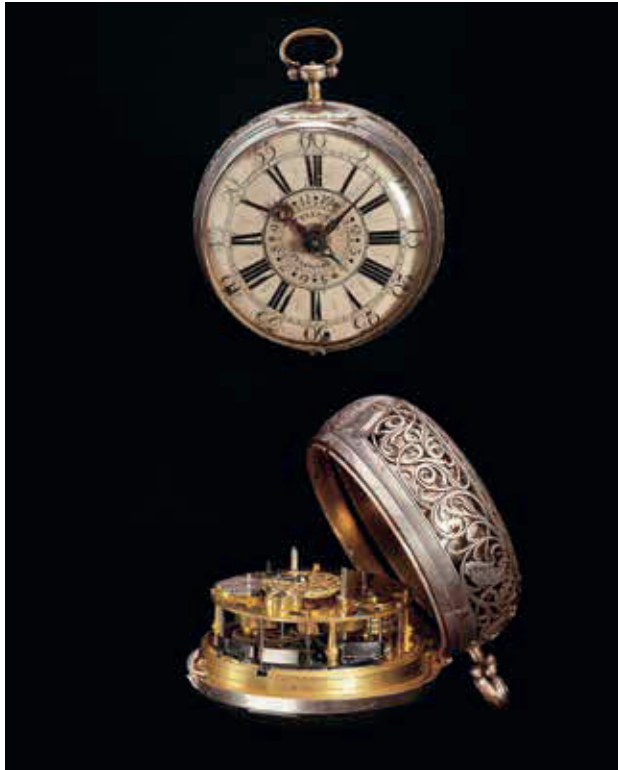
Abb. 1 Kalenderuhr mit Viertelstundenrepetition und Wecker von Joseph Kränckel. (Aukti- onen Dr. Crott, Mannheim, (61) November 2000 Nr. 945, Bild-Nr. 61_27).
