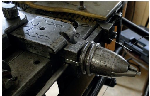
Abb. 13 und 14: Handstopfmaschine, ab 1902 von A. Zahoransky in Todtnau eingeführt. Das bereits mit Löchern versehene Bürstenholz konnte von der Arbeiterin schnell und flexibel per Hand vor das Stopfwerkzeug gehalten werden, und dabei wurde das Borstenbüschel mit einer leicht gekreuzten Drahtschlinge befestigt. Archiv Benno Dörflinger, Todtnau und Detail von einer Zahoransky-Originalmaschine aus der Sammlung des Vereins Kulturhaus Todtnau.
