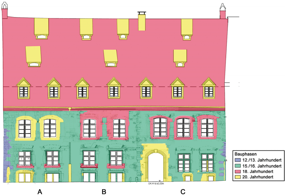
Abb. 4: Die Straßenfassade des „Hinteren Kaufhauses“ zur Schusterstraße. Bauphasenplan 2010: Frank Löbbbecke, Grundlage: Architekturbüro Bühler und Müller.
