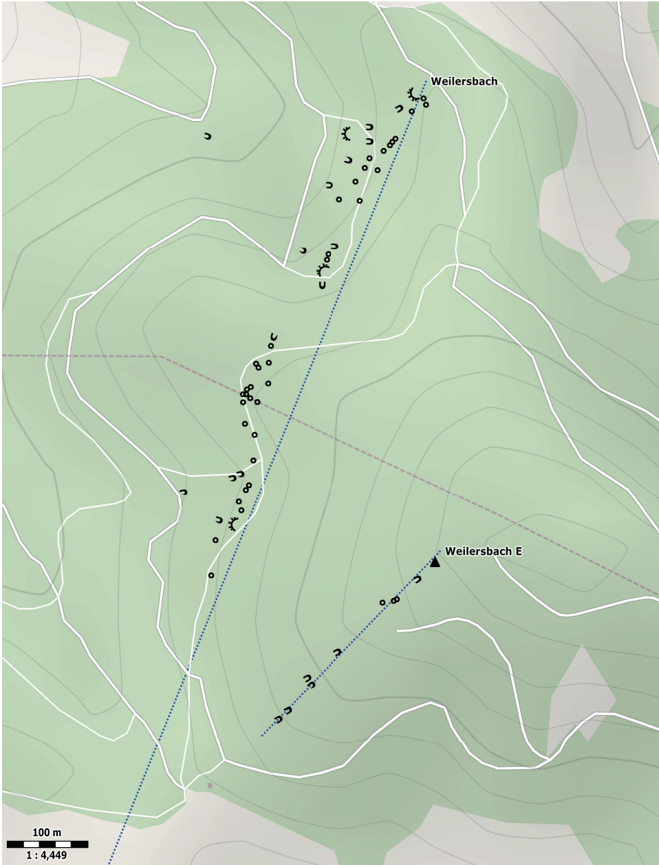
Abb. 8: Übersicht der Bergbauspuen auf dem nördlichen Abschnitt des Erzganges bei Weilersbach-Birkenreute. Hier fällt neben der großen Zahl von Bodenspuen auf, dass die Pingen nicht linienartig hintereinander angeordnet sind, sondern eine breitere Zone bilden, die dem idealisierten Gangverlauf folgt. Dieser Umstand deutet darauf hin, dass hier mehrere Gangtrümer auftreten, die eng benachbart streichen. Etwa in der Mitte der Karte deutet die Lage der Pingen eine Verwerfung an, die den Gang kreuzt und seinen südlichen Abschnitt merklich nach Osten versetzt. Die Tatsache, dass der benachbarte Gang Weilersbach E erheblich schwächer bebaut wurde, lässt auf eine geringere Erzführung als im Weilersbach-Gang schließen. Grafik: Helge Steen.
