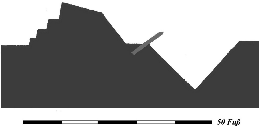
Abb. 24: Wallprofil der Ettlinger Linien. Zeichnung: Martin Straßburger nach K. Lang, Ettlinger Linien, S. 19, Skizze 1
