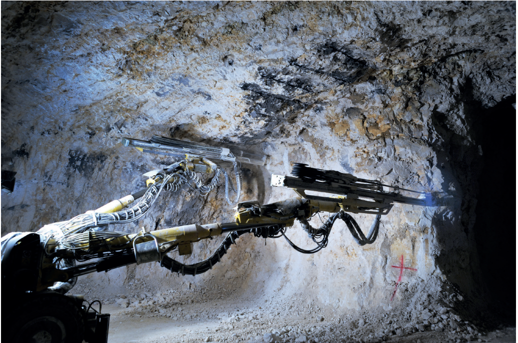
Abb. 25: Gewinnung von hochreinen Kalksteinen im Bergwerk Mähringer Berg bei Ulm. Im Bild ein Bohrwagen beim Bohren von Sprenglöchern. Foto: Fa. Sachtleben Mining Services, 2012.
