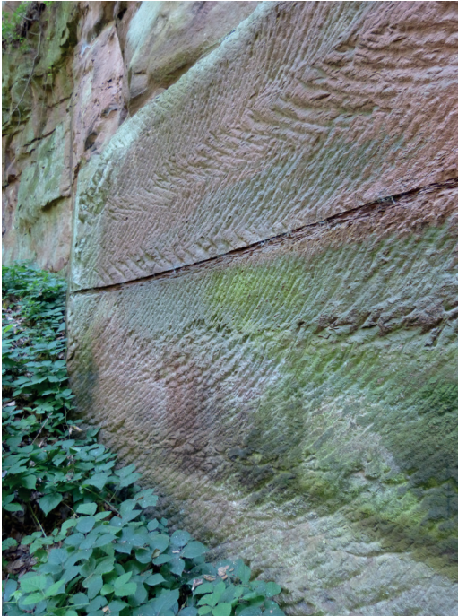
Abb. 56: Historischer Sandsteinbruch bei Teningen-Heimbach; hier wurde Buntsandstein vom Mittelalter bis ins 20. Jahrhundert abgebaut. Die Vorräte an hochwertigem Werkstein sind trotz früherer umfangreicher Gewinnung weiterhin immens. Foto: Wolfgang Werner, LGRB.
