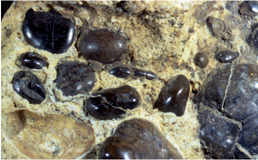
Abb. 9: Bohnerze der Schwäbischen Alb, ein bis ins 19. Jahrhundert hinein wichtiges Eisenerz. Bohnerz-lehm aus dem Gebiet Albstadt; Größe der Eisenerz-„Bohnen“ 1–4 mm. Foto: Wolfgang Werner, LGRB.
