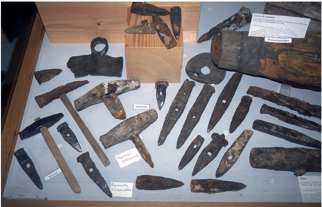
Abb. 52: Schlägel und Bergeisen aus den Gruben um Markirch/Sainte-Marie-aux-Mines, überwiegend aus dem 16. Jahrhundert, Heimatmuseum in Sainte-Marie-aux-Mines. Foto: Wolfgang Werner, LGRB.
