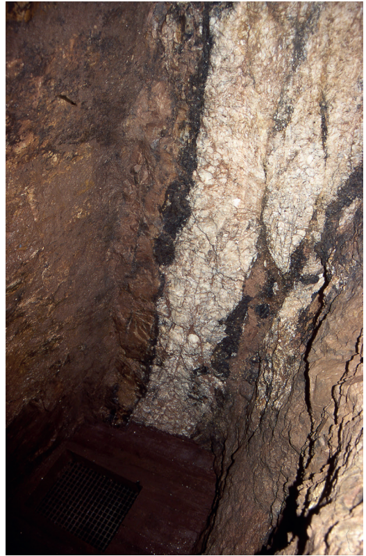
Abb. 34: Beispiel für einen Gangaufschluss in den historischen Bergwerken bei Freudenstadt: Steilstehender Schwerspatgang mit randlichem Brauneisenerz im Besucherbergwerk Freudenstadt (Lage s. Abb. 33). Wie die Erkundung durch die 2008 abgeteufte 292 m tiefe LGRB-Bohrung zeigte, nimmt zur Tiefe hin der Flussspatgehalt der Gänge stark zu. Foto: Wolfgang Werner, LGRB.
