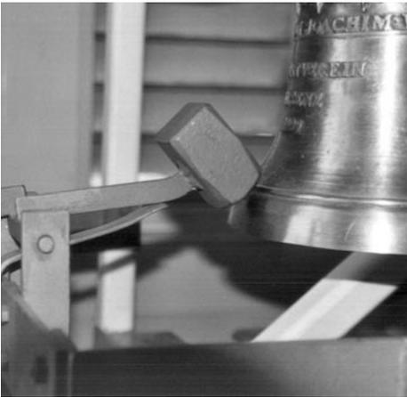
*Der Fallhammer. Er ist auf einem Hebel so angeschweißt, dass er die Glocke am unteren Rand anschlägt. Im Ruhezustand berührt er die Glocke nicht. Das Schlagwerk hebt über Nocken den Hammer an und lässt ihn plötzlich fallen. Die unterhalb angebrachte Prellfeder verhindert den mehrfachen Anschlag der Glocke. Durch die in ihrer Länge verstellbaren Stangen lässt sich die Wirkung der Prellfeder einstellen.*
