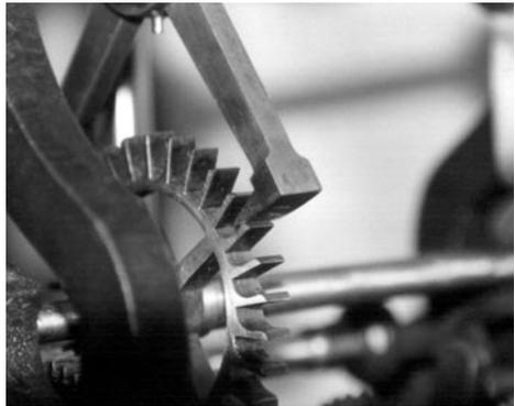
*Die Hemmung besteht aus dem Ankerrad und dem Anker ( Ankerhemmung ). Sie bremst den unkontrollierten Ablauf des Räderwerks und setzt die Drehbewegung in eine Hin- und Herbewegung für das Pendel um.*
