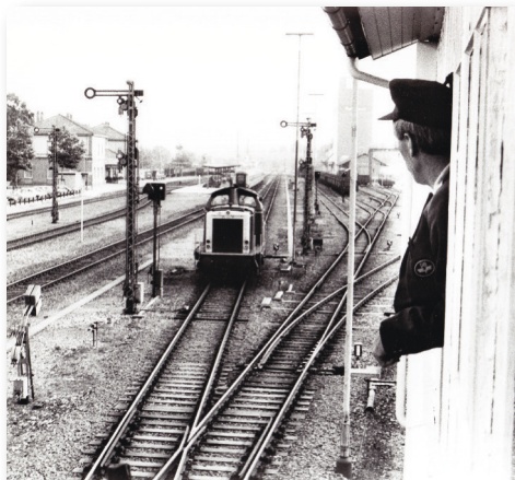
Ein Personenzug aus Heilbronn ist in Eppingen angekommen. Die Diesellokomotive setzt über Gleis 4 an das andere Zugende um. Der Weichenwärter von Stellwerk „Eppingen West“ überwacht das Rangiermanöver.
