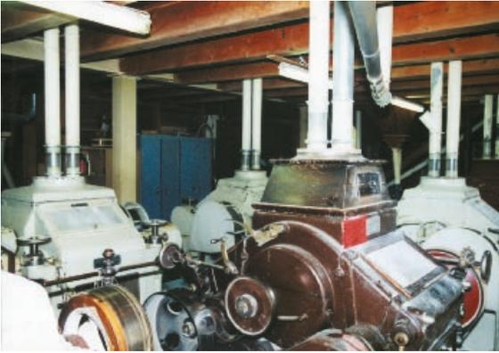
*Anstelle der früheren Mahlsteine zerteilen heute Walzenstühle mit geriffelten Stahlwalzen die Getreidekörner in Schrot, Grieß, Dunst und Mehl.*
