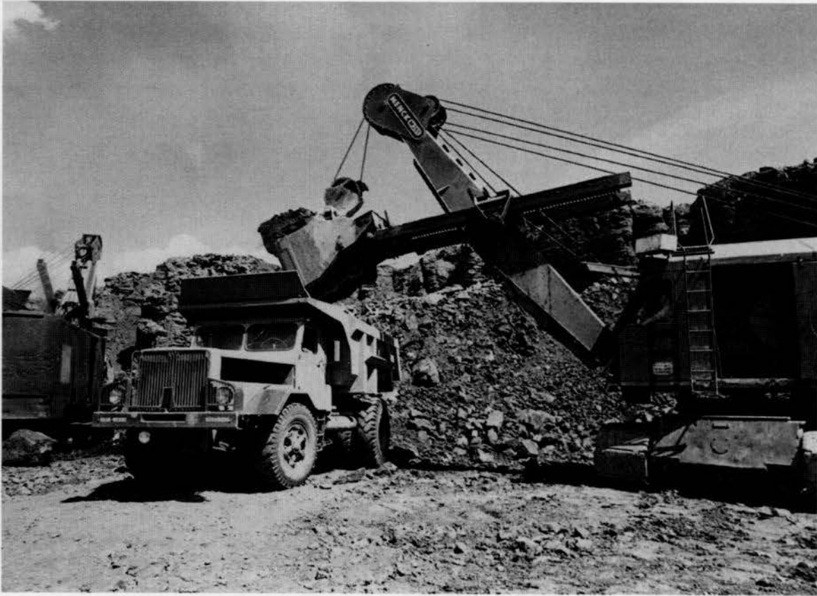
Abb. 4: Erzgewinnung durch Seilbagger, Großraummulde als Transportmittel
