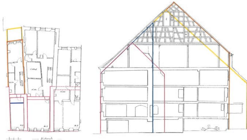
Abb. 3: Grundriss und Schnitt von B. Lobrum/ rote Baulinie zeigt die Bauphase des 13. Jahrhunderts, die blaue Baulinie die des 14. Jahrhunderts, die gelbe Baulinie vermutlich die des 15./16. Jahrhunderts und die orangene Baulinie die Kubatur ab 1706 bis heute.
