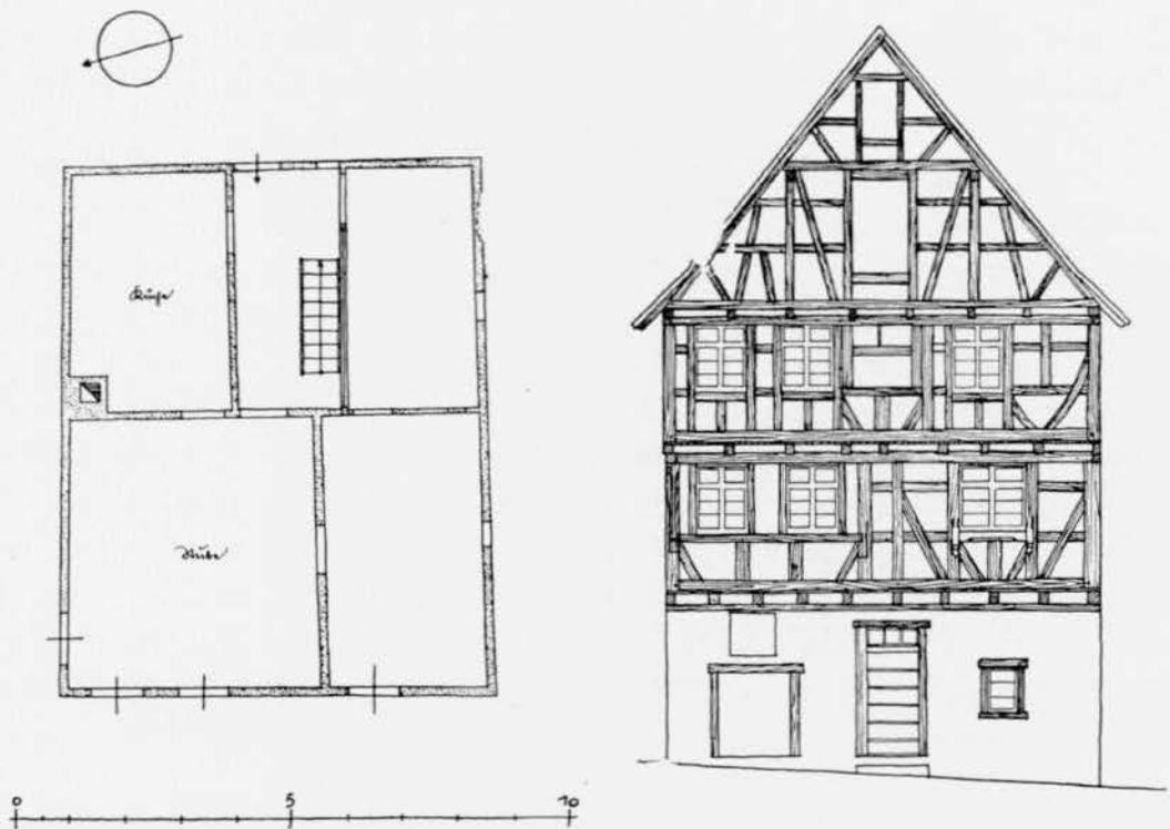
Das Haus Spitalstraße 23, vermutlich nach dem Brand 1590 erbaut, gilt als Grundtypus des damaligen zweigeschossigen Giebelhauses mit gesonderter, „kistenweiser“ Abzimderung vorkragender Fachwerkgeschosse, Hauseingang im gemauerten Erdgeschoß von der Giebelseite aus und unregelmäßiger Fassadengliederung.
