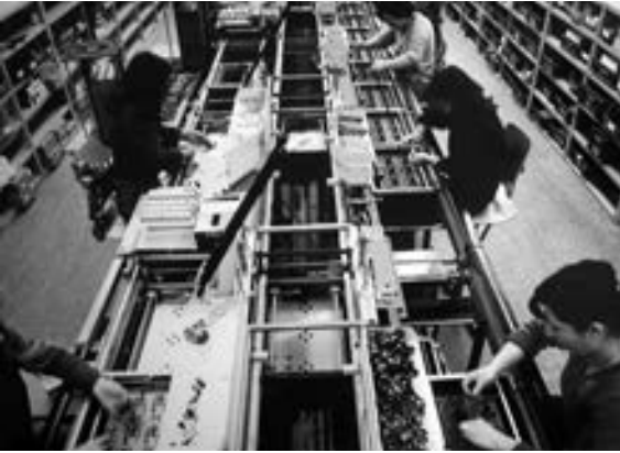
Abb. 10: Bestückungslinie für Bildrohrplatten und Pal-Decoder.
