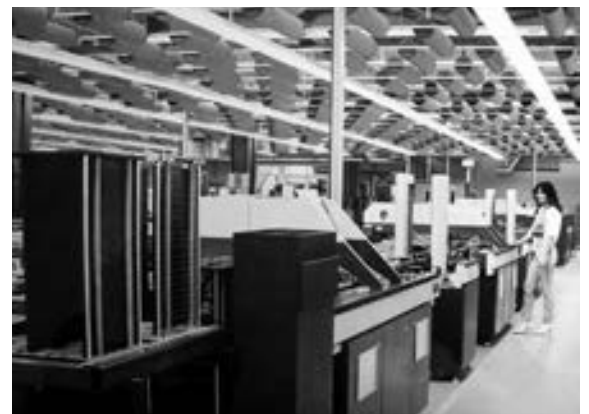
Abb. 9: Automatische Leiterplattenbestückung November 1982.
