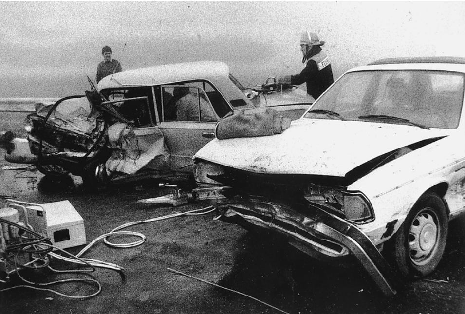
Einsatz des Spreizers bei einem Verkehrsunfall auf der B 293 zwischen Eppingen und Rohrbach. Links vor den Unfallfahrzeugen ist die Hydraulikpumpe zu erkennen; in der Mitte der abgelegte Spreizer. Ein weiterer Spreizer ist auf dem Kofferraumdeckel des linken Fahrzeugs im Einsatz.
