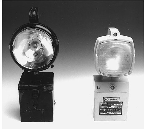
Handscheinwerfer mit Bleiakku um 1950 (links) und rechts moderner EX-geschützter. Der moderne kann auch abgeblendet und als Blinklicht betrieben werden.
