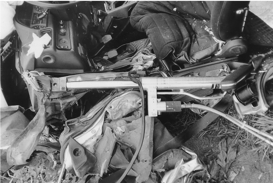
Einsatz der Hydrostange bei einem schweren Verkehrsunfall. Die Hydrostange drückt vorderer Holm und Türholm bei einem Pkw auseinander.
