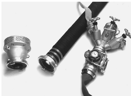
Der Saugkorb mit A-Anschluß verhindert die Ansaugung größerer Schmutzteile (links). Saugschlauch ca. 1,6 m lang mit A-Anschluß (Mitte). Modernes, einstellbares Druckbegrenzungsventil mit Verteiler; B Eingang und drei C-Abgängen (rechts).
