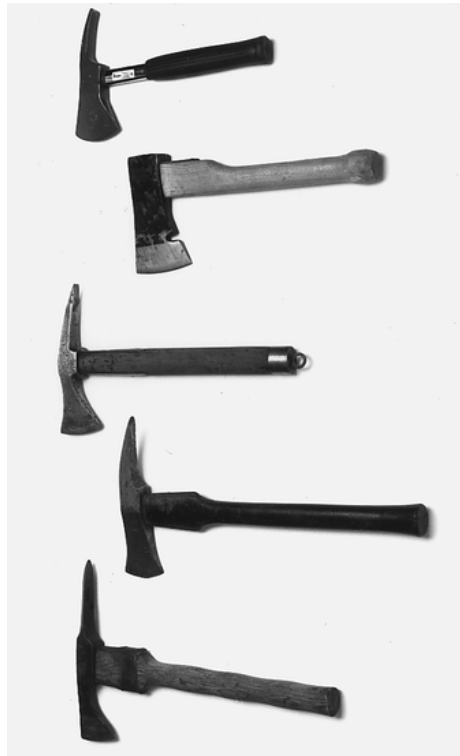
Beile von 1860 (unten) bis heute (oben) im Wandel der Zeiten - von Spitzbeil über das einseitige Beil zurück zum
