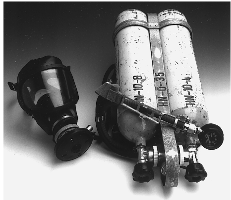
Atemschutzmaske (links) und Preßluftflaschen 2x4 Liter bei 200 bar; 1600 Liter Atemluft (rechts).
