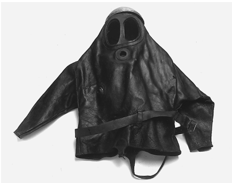
Rauchschutzmaske aus Leder mit Messinghelm und Anschlüssen für die Luftzuführung über Lederschlauch.
