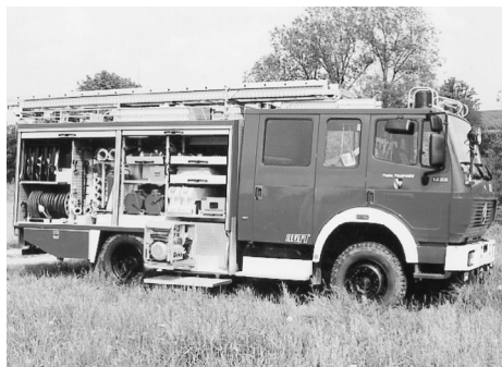
Löschfahrzeug LF 16/12 mit Schnellangriff und Notstromaggregat.
