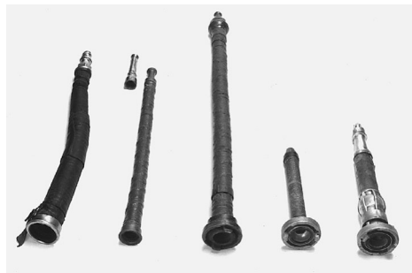
100 Jahre Strahlrohre. Von links nach rechts: Aus Lederstreifen zusammengenähtes Strahlrohr, Strahlrohre der Stadtspritzen (2. und 3.), Strahlrohre ohne Absperrmöglichkeit der ersten Motorspritzen von 1932.
