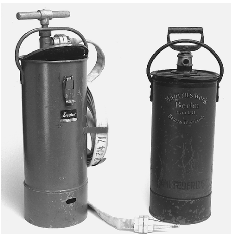
Nur sehr wenig hat sich die Form und das Prinzip der Kübelspritze von 1930 bis heute geändert. Links eine heute noch gebräuchliche, rechts eine aus den 30er Jah-
