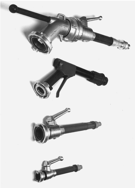
Moderne Strahlrohre. B-Strahlrohr mit Stützkrümmer zum Ableiten der Rückstoßkraft des Wasserstrahls auf die Erde, C-Strahlrohr in Pistolenform zum kontinuierlichen Verstellen des Wasserstrahls von Vollstrahl bis zum Sprühstrahl, C-Strahlrohr, D-Strahlrohr der Kübelspritze.
