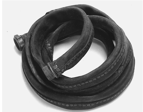
Der Lederschlauch um 1830 ist aus Lederstreifen zusammengenäht und mit Kupfernieten verstärkt (Feuerwehrmuseum Eppingen).
