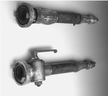
Nicht abstellbares Strahlrohr (oben) und abstellbares Strahlrohr mit zylindrischem Absperrschieber um 1930 (unten).
