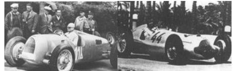
„Silverpfeile“ von Mercedes Benz und der Autounion gab es schon damals (1934 erfunden). Sie erreichten 390 bzw. in der Stromlinienausführung 430 km/Std.)
