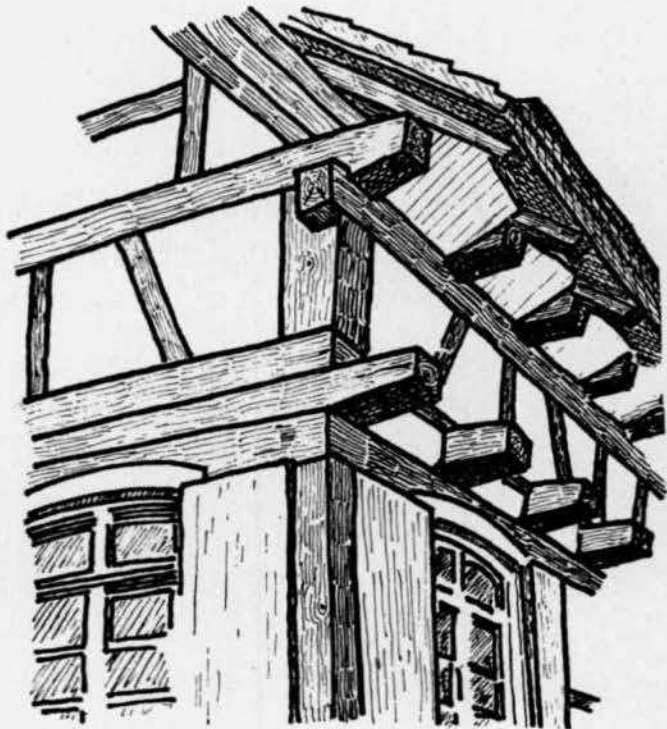
Abb. 39a. Hausecke mit vorspringender Balkenlage aus Schufferwald.
