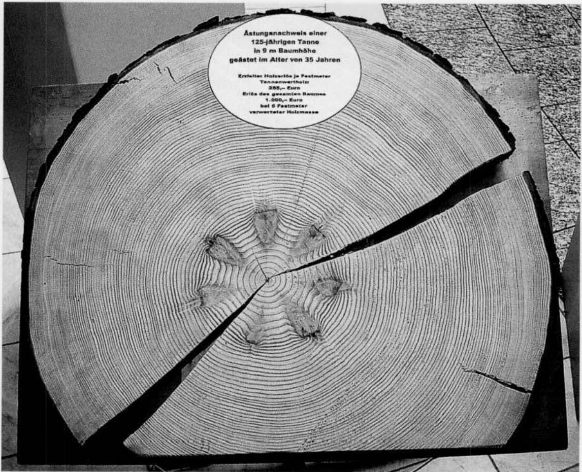
Abb. 3: 125-jährige Tanne aus dem Wolfacher Forst-Revier, (Querschnitt in 9 m Höhe, Ästung mit 35 Jahren: Es entstehen 6 fm verwertbares Furnier-Tannenholz des Stammes, sie ergeben etwa einen Erlös von 1000,- Euro.) Derartige Trockenrisse entstehen natürlich nur in der frisch geschnittenen Baumscheibe, nicht im Stamm selbst (Ausstellung in der Wolfacher Sparkasse 2004, Foto: Schüssler).
