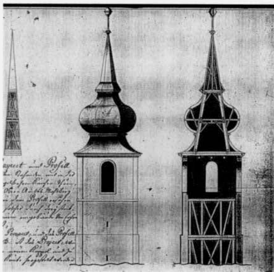
Plan der neuen Turmhaube für den Kirchturm der Kippenheimer Kirche von Franz Ignaz Kromer
