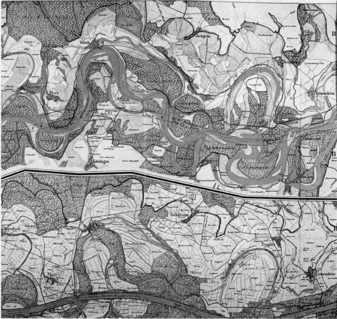
Der Rhein bei Karlsruhe und Würth vor und nach der Korrektion 1817. (GLA Karlsruhe H-c / 62; aus: Honsell, Korrektion des Oberrheines)
