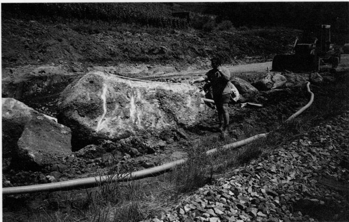
Abb. 8: Groß-Erratikum aus feinkörnigem Seebachgranit (> 150 t Gewicht) in der Grundmoräne der Umgehungsstraße bei der Station Kappelrodeck-Ost. Untergrund: grobkörniger Achertalgranit.
