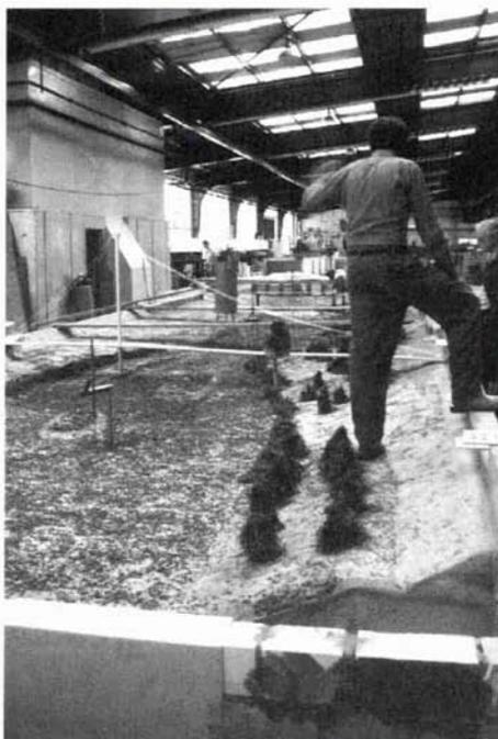
Abb. 5: Im Flußbauinstitut der Universität Karlsruhe werden Fließstrecken renaturierter Wasserläufe im Modell erprobt
