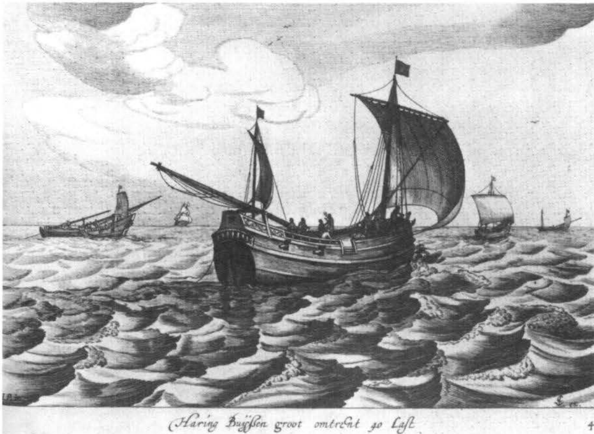
Abb. 2 Jan Porcellis (ca. 1584-1632) Heringsbüse, ungefähr 40 Lasten groß. Wie die Schiffe am linken und rechten Bildrand sowie in der Bildmitte zeigen, konnten bei der Büse zum besseren Arbeiten mit den Fischernetzen die Masten umgelegt werden. Zum Aussetzen und Einholen der Netze besaßen die Büsen mittschiffs in der Bordwand eine breite Öffnung, wie sie bei dem Schiff im Vordergrund deutlich zu sehen ist (aus: EICH/WEND [wie Anm. 3], S. 75).
