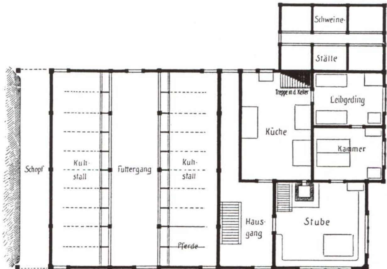
Abb. 6a Grundriss eines typischen Dreisamtäler Hauses, wie er für diesen Haustyp ab dem 17. Jahrhundert üblich wurde. Bei den früheren Bauernhäusern des Dreisamtals war die Küche in der Mitte der Giebelseite angeordnet, erst im Laufe des 17. Jahrhunderts rückte sie an die dem Wohnungszugang gegenüber liegende Traufseite (aus: RICHARD SCHILLING: Das alte malerische Schwarzwald-Haus. Freiburg 1915)
