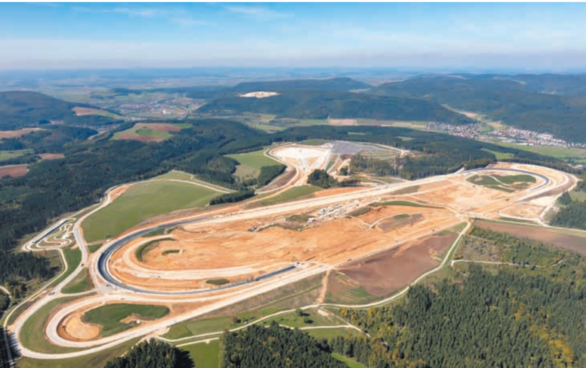
Das Prüfzentrum nimmt Form an: Flächenbestimmend ist der sogenannte Ovalrundkurs, der bei Fahrversuchen einer unendlichen Geraden gleichkommt.
