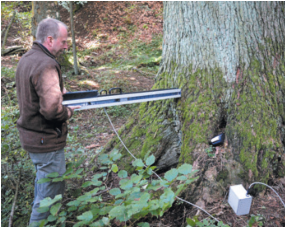
Schonende Altersermittlung mit dem Resistographen (Fa. Rinntech).
