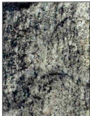
Abb. 13: Gesteinsoberfläche, die längere Zeit offen, aber vor direkten Niederschlägen und Licht geschützt, gelegen hat. Die oberflächlich angewitterten Feldspäte erscheinen getrübt; das Glimmergefüge ist noch gut erkennbar
