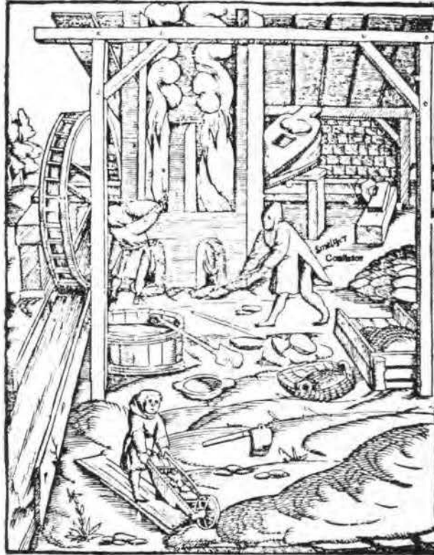
Abb. 4. Das mit Hand geförderte Erz wurde nach dem Trennen vom tauben Gestein und Pochen im Pochwerk der Hütte zugeführt. Hand- und wasserkraftbetriebene Blasebälge erleichtern die Arbeit am Rennofen, in dem das Rösten und anschließende Reduzieren des Erzes vorgenommen wird. Man erkennt oben eine Probenahme. Die primitive Technik dieser Anlagen war umweltbelastend und in hohem Maße energieverbrauchend.
