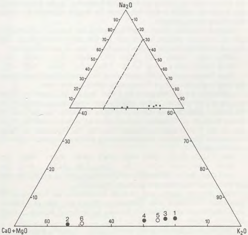
Abb. 19: Lage der Zusammensetzung der Gläser nach den Rezepten 1 bis 4 im System Na 2 O - CaO+MgO - K 2 O. Zum Vergleich die durchschnittliche Zusammensetzung unverwitterter Pottasche- (5) und Aschegläser (6)
