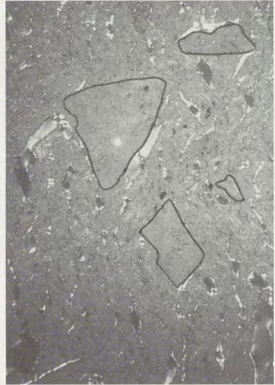
Abb. 5: Dünnschliff eines Glashafens von Schönmünzach mit eingearbeiteten Bruchstücken eines älteren Glashafens (umrandet). Linkes Bild: normales Licht; rechtes Bild: gekreuzt polarisiertes Licht. Vergrößerung: Lange Bildkante 3 mm
