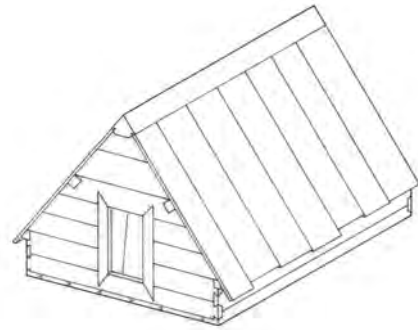
Abb. 5: Kornkasten mit 5-eckigem Quer-schnitt. Zeichnung: Stefan Blum, 2003
