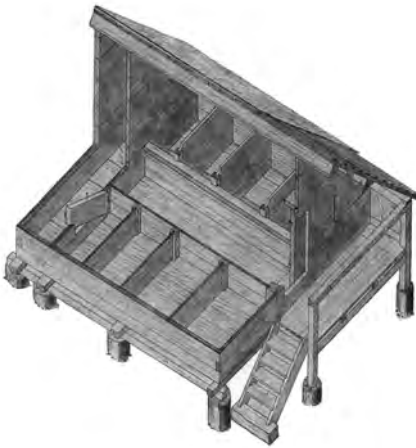
Abb. 14: G’halt eines im Querschnitt 5-eckigen Kornkastens. Zeichnung: Hermann Schilli; Das Schwarzwaldhaus, Stuttgart 1953, S. 216
