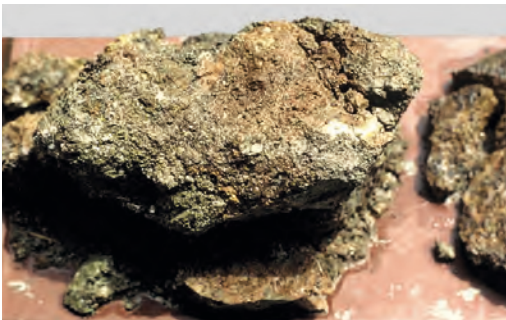
Abb. 24: Tephrit-Pyroklastit aus dem Steinbruch Büchsenberg; ursprünglich ganzes Stück nach sechsmonatiger Exposition im Freien; Breite des Bildausschnitts: ca. 19 cm. Foto: W. W.
