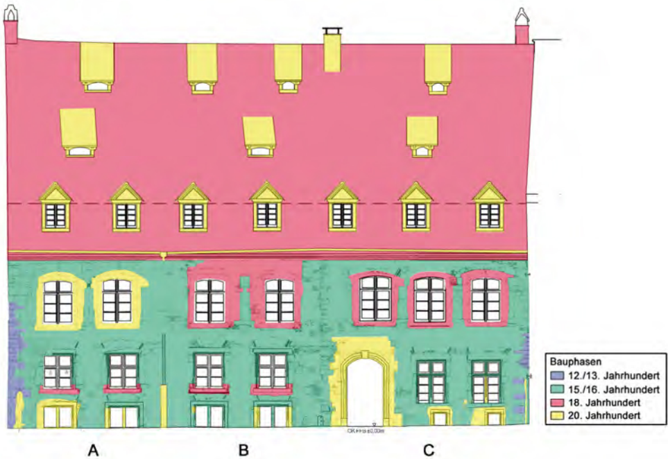
Abb. 4: Die Straßenfassade des „Hinteren Kaufhauses“ zur Schusterstraße. Bauphasenplan 2010: Frank Löbbbecke, Grundlage: Architekturbüro Bühler und Müller.
