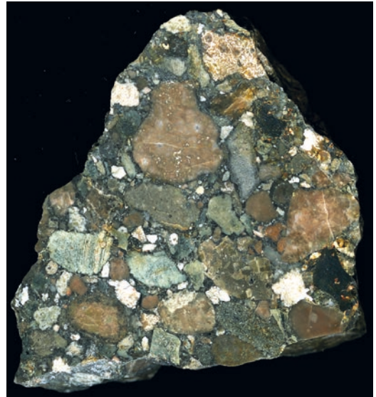
Abb. 16: Stark verkieseltes, kulmisches Konglomerat mit Goldführung vom Weiherkopf südöstlich Bad Sulzburgs. Sowohl die ehemaligen Gerölle als auch das Bindemittel enthalten unzählige kleine Pyritkörner. Das Gold tritt als Freigold in zumeist nur mikroskopischen Größen auf. Bildbreite 7 cm. Foto: Helge Steen.
