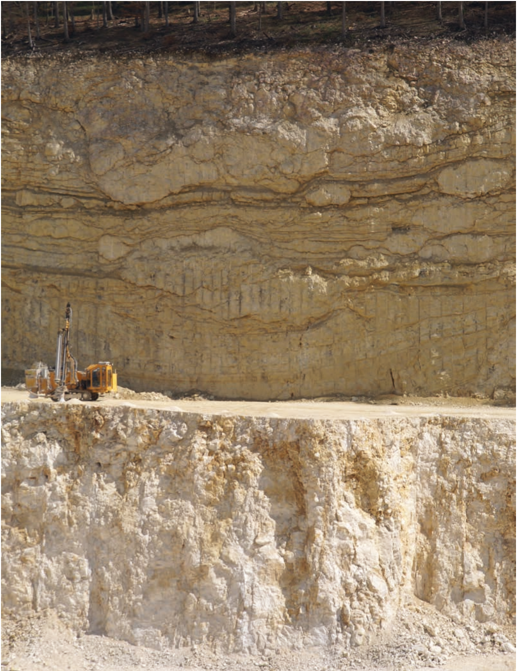
Abb. 20: Im hohen Oberjura des Blautales werden auch sehr reine, massig bis undeutlich geschichtete Kalksteine abgebaut. Das Foto zeigt zwei Sohlen im Steinbruch Gerhausen der Fa. Dr. Merkle. Die großen rundlichen Schollen in der oberen Bildhälfte werden als abgeglittene Riffblöcke (Olistolithe) gedeutet, welche in feingeschichtete, tonigere Kalkschlämme eingebettet wurden. Foto: Helmut Bock, LGRB.
