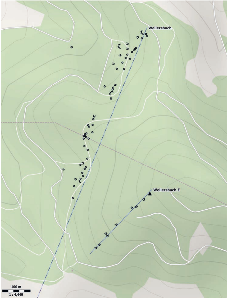
Abb. 8: Übersicht der Bergbaus Spuren auf dem nördlichen Abschnitt des Erzganges bei Weilersbach-Birkenreute. Hier fällt neben der großen Zahl von Bodenspuren auf, dass die Pingen nicht linienartig hintereinander angeordnet sind, sondern eine breitere Zone bilden, die dem idealisierten Gangverlauf folgt. Dieser Umstand deutet darauf hin, dass hier mehrere Gangtrümer auftreten, die eng benachbart streichen. Etwa in der Mitte der Karte deutet die Lage der Pingen eine Verwerfung an, die den Gang kreuzt und seinen südlichen Abschnitt merklich nach Osten versetzt. Die Tatsache, dass der benachbarte Gang Weilersbach E erheblich schwächer bebaut wurde, lässt auf eine geringere Erzführung als im Weilersbach-Gang schließen. Grafik: Helge Steen.
