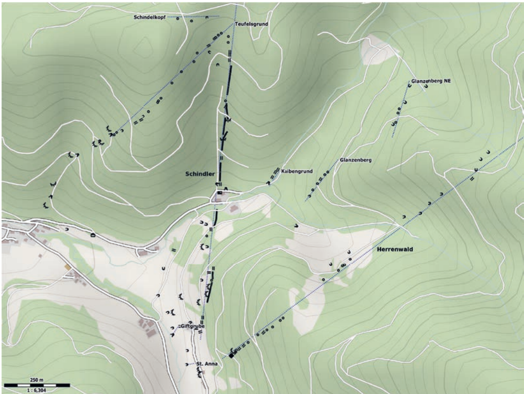
Abb. 6: Im Muldental, einem Seitental des südöstlichen Münsdertals, bildete eine Gruppe von Mineralgängen mit recht reichlicher Erzführung die Rohstoffgrundlage für ein Bergbauzentrum, das vom Mittelalter bis ins 19. Jahrhundert produktiv war. Der intensive, alte Betrieb hinterließ eine enorme Zahl an Pingern, Halden und Verhauen auf den Gangausschüssen, während die jüngsten Baue meist als Querschläge in tiefen Niveaus angelegt wurden. Die detaillierte Einmessung der Oberflächenspuren auf dem Teufelsgrundgang zeigt einen leicht sigmoiden Gangverlauf, während die auf einzelne Gangabschnitte konzentrierte Lage der Schürfe auf dem Herrenwaldgang auf einen Wechsel von Ganglinsen mit tauben Zonen hinweist. Links im Talgrund, wenig östlich der Häuser von Mulden, befand sich das Mundloch des Erbstillens, der noch im Spätmittelalter auf den annähernd N-S streichenden Schindlergang aufgeföhren worden ist, um die dortigen Baue unter der Talsohle zu entwässern. Grafik: Helge Steen.
