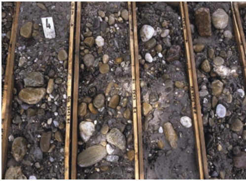
Abb. 14: Kies in einer Rohstofferkundungsbohrung bei Schutterwald. Foto: Wolfgang Werner, LGRB.
