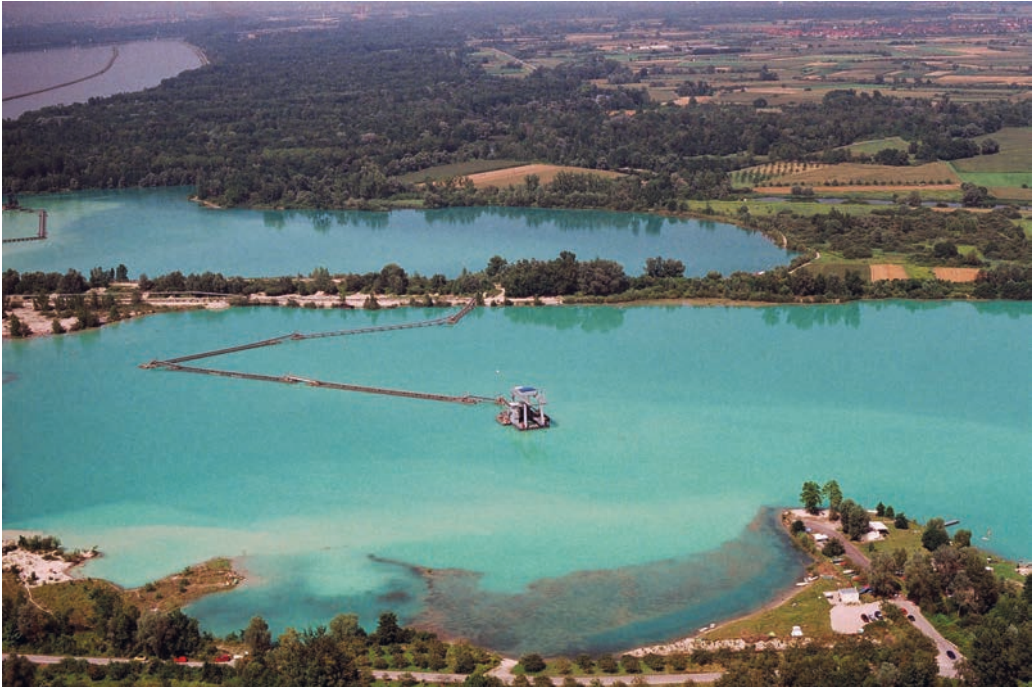
Abb. 5: Große Kiesgruben am Oberrhein bei Meißenheim (Ortenaukreis); die Gewinnung erfolgt mittels Schwimmbagger, welche einen Nassabbau bis 80 m Tiefe erlauben. Die neu entstandenen Seeflächen sind auch Freizeitgebiet (Vordergrund). Foto: Heinz Schlecht, Fa. RMKS.
