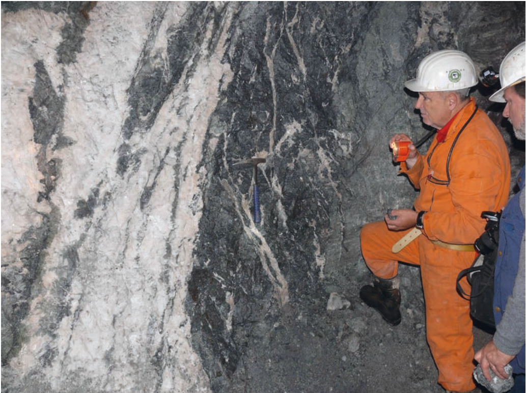
Abb. 55: Fahlerzreicher Schwerspatgang auf der Grube Clara, Sohle 15.1. Foto: Birgit Kimmig, LGRB.
