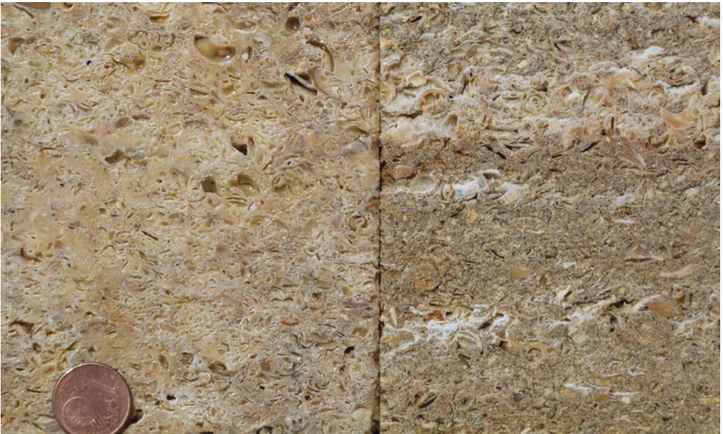
Abb. 22: Im Jungtertiär kam es auf den Stränden des Molassemeeres zur Ablagerung von mehrere Meter mächtigen Schillbänken; sie bestehen überwiegend aus kalkigen Schalenresten. Diese sogenannten Randengrobkalke werden seit römischer Zeit für Mauer- und Mahlsteine gewonnen. Die Platten stammen aus einem Steinbruch bei Wiechs am Randen. Bildbreite entspricht 13,5 cm. Foto: Wolfgang Werner, LGRB.
