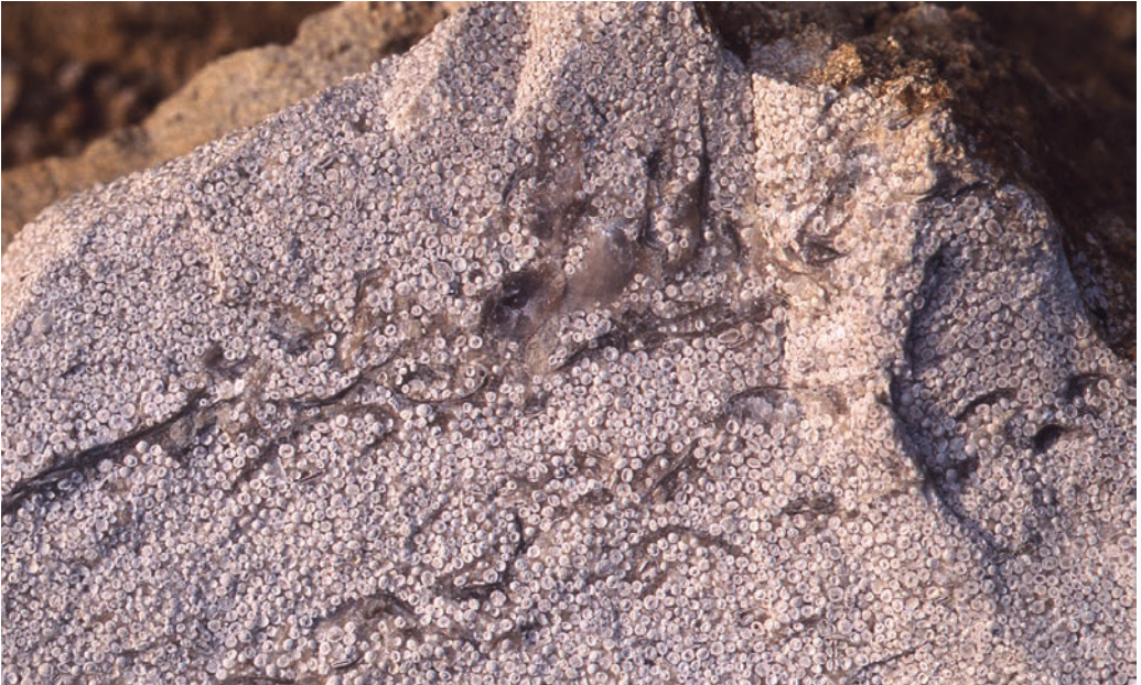
Abb. 21: Im Mitteljura des südlichen Oberrheingrabens werden die aus kleinen Kügelchen aufgebauten Kalksteine der Hauptrogenstein-Formation für die Kalkindustrie gewonnen. Die Oolithe sind in sehr flachem, bewegtem Wasser entstanden. Bildbreite entspricht ca. 10 cm. Foto: Wolfgang Werner, LGRB.
