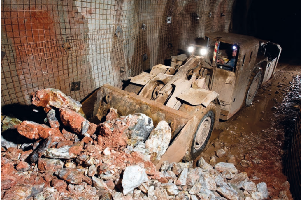
Abb. 54: Lader im Streckenvortrieb auf der Fluss- und Schwerspatgrube Clara bei Oberwolfach, Mittlerer Schwarzwald. Foto: Sachtleben Bergbau GmbH.
