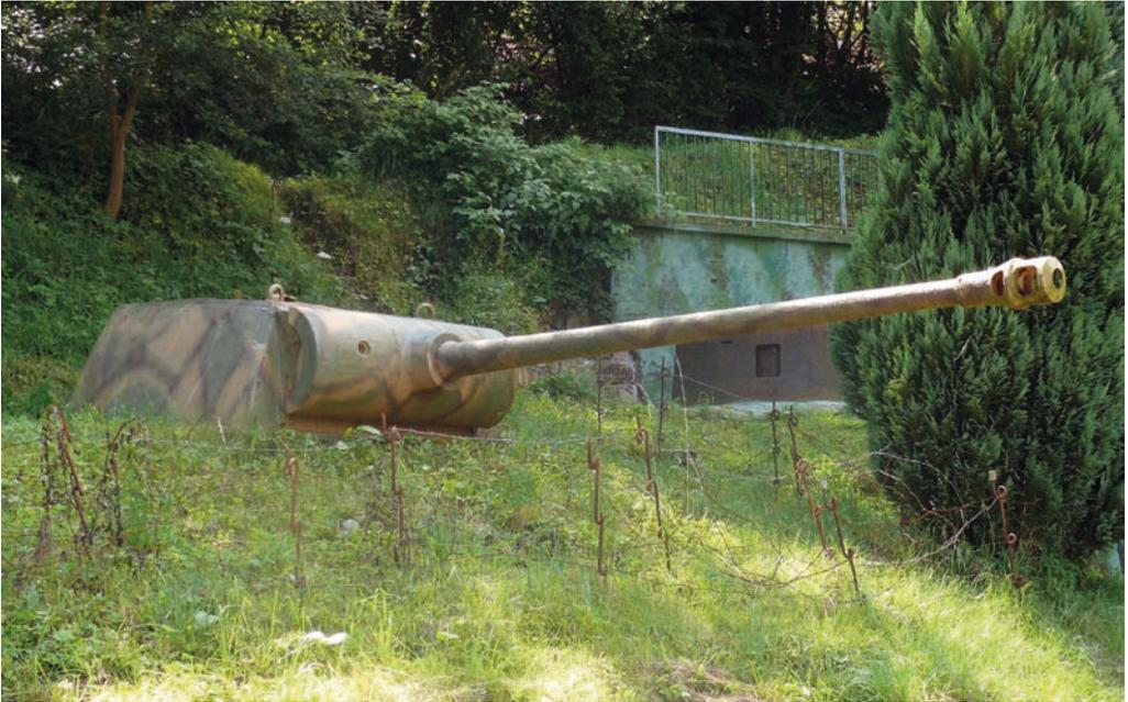
Abb. 8: Auf die Panzerabwehr wurde 1944 großen Wert gelegt. Da moderne mobile Panzerabwehrkanonen kaum verfügbar waren, wurden Türme von Kampfpanzern wie die „Pantherturn“ oder aus Panzern ausgebaute Waffen ortsfest zum Einsatz gebracht. Foto: Friedrich Wein.
